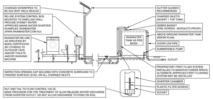
TYPICAL ABOVE-GROUND RAINWATER RE-USE TANK DETAIL
